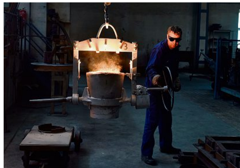
Steffen Schnabel balanciert die Pfanne am Kranhaken in die richtige Position.
