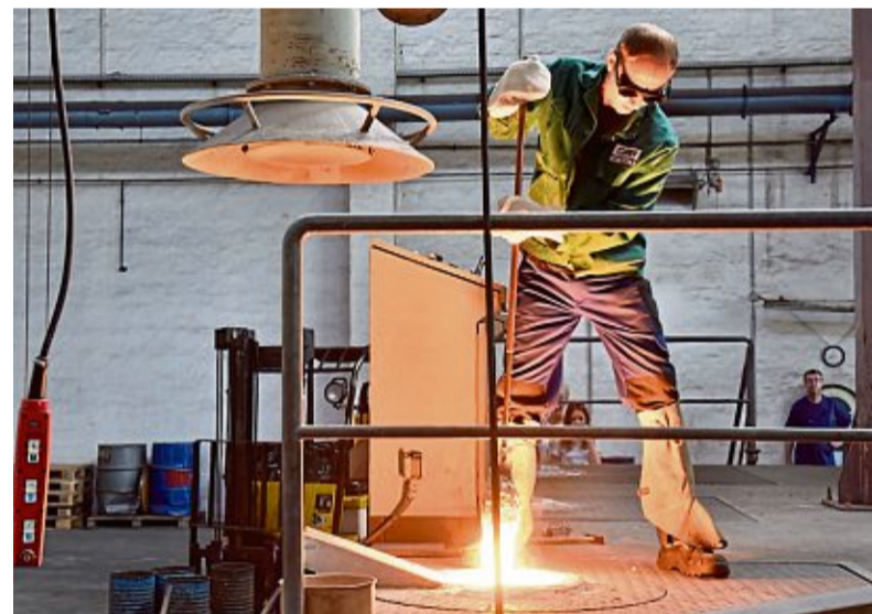
René Richter bereitet den Schmelzofen für den Abstich vor.
